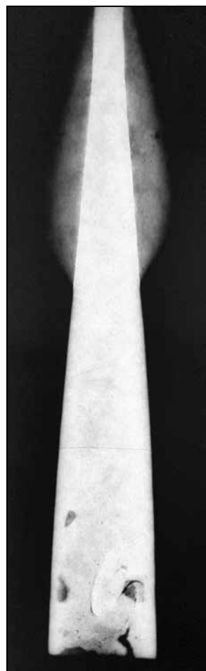
Рис. 2. Дефекты литья, место соединения (?) двух частей втулки литого наконечника копья 1400:26.
